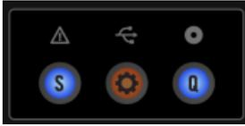
Les boutons S (Snap), Q (Quantize) et Settings, et les indicateurs status/mode situés juste au-dessus.
