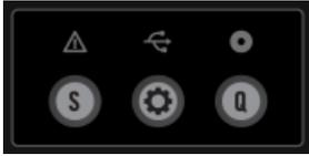
Les indicateurs status/mode et les boutons S (Snap), Q (Quantize) et Settings situés juste en-dessous.
