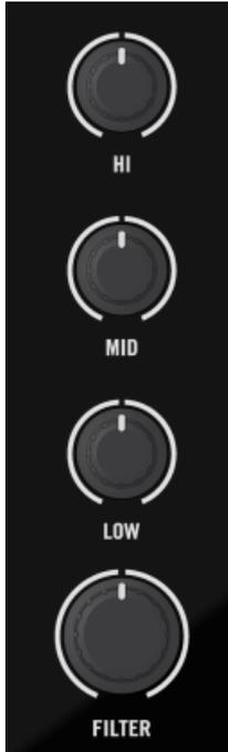
Les curseurs EQ (HI, MID et LOW) et FILTER d'un canal, sur le panneau supérieur.
