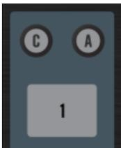
Les boutons Deck Focus C et A, situés au-dessus de la section Cue/Sample Trigger de gauche, sur le Z2.
